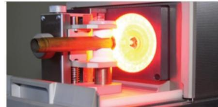
Escaneo del cabezal de la caja del cartucho con luz anular
