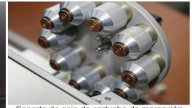
Soporte de caja de cartucho de marcación automática para escaneo continuo
